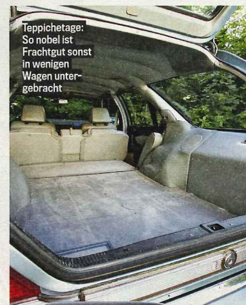
Klappt nur mit Nachhilfe: Die Rückbanklehne fährt per Knopfdruck abwärts – aber erst nachdem die Sitzfläche per Hand aufgestellt worden ist – ein seltsames System
